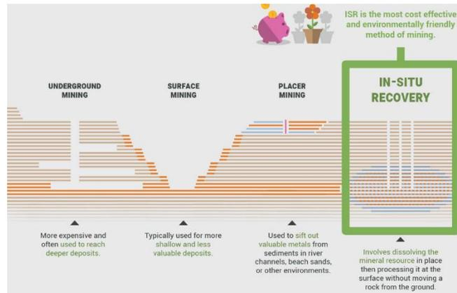
Gambar 2. Perbandingan *Insitu Recovery (ISR) Mining* dengan Metode Tambang Umum
