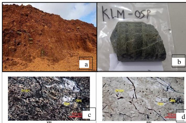
**Gambar 6.** a. Singkapan Lapukan Batuan Peridotit; b. Sampel Batuan Peridotit; c. Sayatan Batuan Peridot XPL; d. Sayatan Batuan Peridot PPL.
