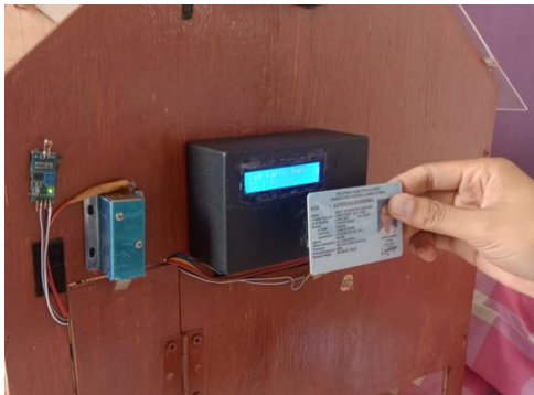
Gambar 5. Proses Scan E-KTP Pada Pembukaan Pintu
