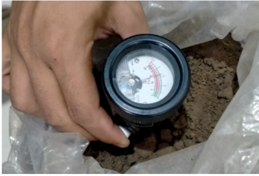
Gambar 2. Pengukuran kelembaban pada sampel
