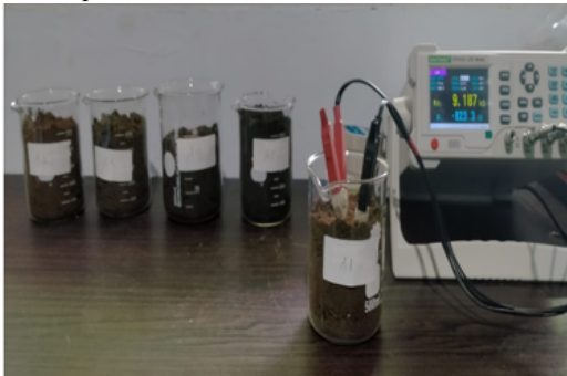
Gambar 3. Pengukuran nilai impedansi sampel
