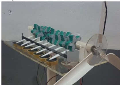
Gambar 6. Prototype pengujian piezoelektrik dengan sumber energi angin
