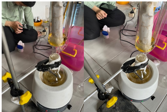
Gambar 7 Proses ekstraksi minyak menggunakan alat sokletasi
