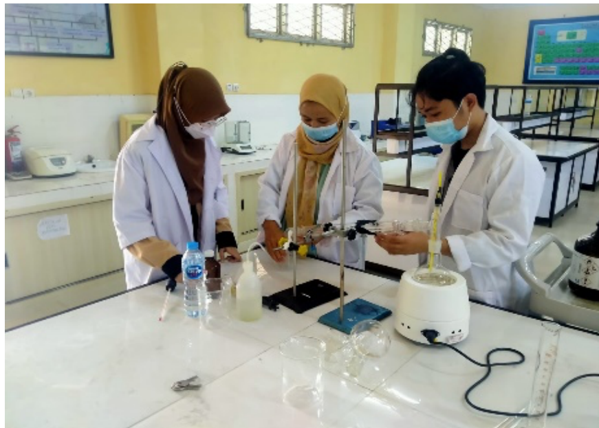
Gambar 1 Perangkaian alat sokletasi dan destilasi
