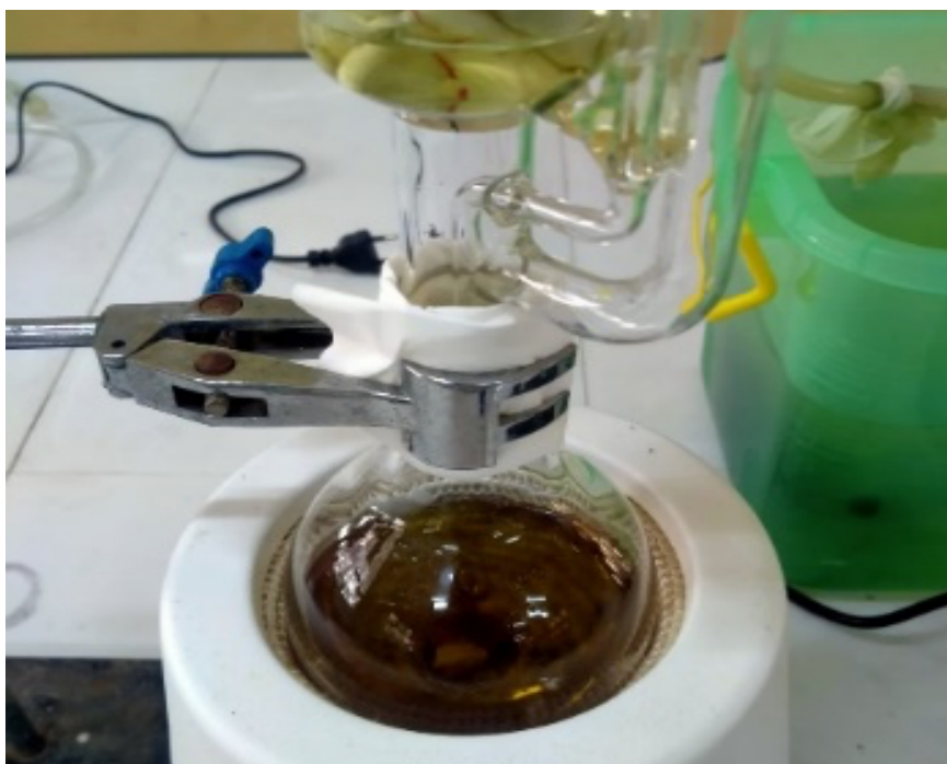
Gambar 4 Pemisahan minyak dan pelarut menggunakan alat destilasi
