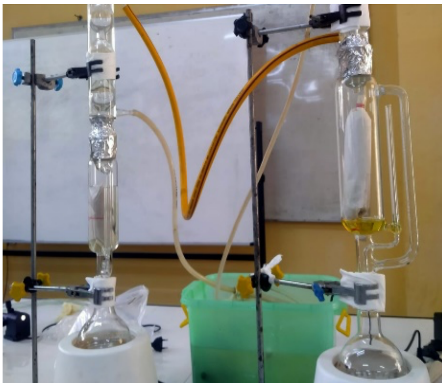
Gambar 2 Proses ekstraksi minyak menggunakan alat sokletasi
