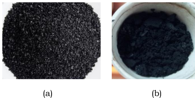
Gambar 1. Karbon Aktif Cangkang Kelapa Sawit, (a) Sebelum aktivasi, (b) Setelah Aktivasi
