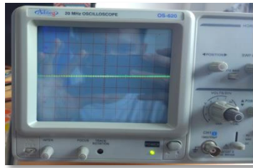
Gambar 8. bentuk gelombang PWM pada saat potensiometer diputar 25 %
