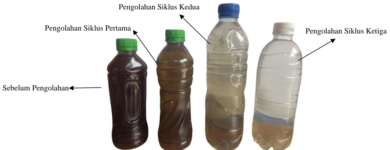
Gambar 4. Perubahan warna limbah batik dari beberapa siklus pengolahan
