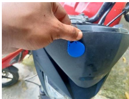
Gambar 3. Pengujian RFID untuk menghidupkan sepeda motor
