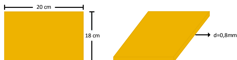
Gambar 1. Dimensi Elektroda Plat Tembaga
