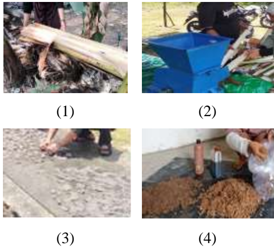
Gambar 2. Proses pengolahan Batang Pisang, 1). Pengumpulan Batang Pisang, 2). Penggilingan, 3). Pengeringan, 4). Tepung Batang Pisang
