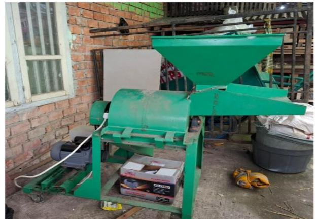
**Gambar 6 . Mesin Pencacah yang telah dimodifikasi dengan Motor Listrik**
