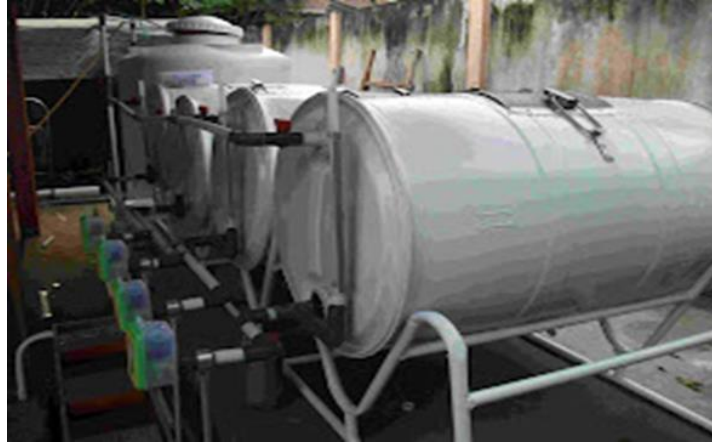
Gambar 1. Bioreaktor Pembangkit Pupuk Cair (BPPC) Dede Martino
